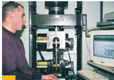
Zugversuch mit Feindehnungsmessung
