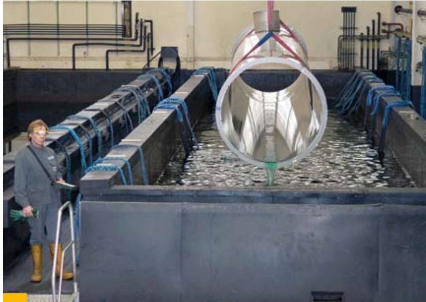
Die BUTTING-Vollbadbeizung – eine ökonomische und umweltgerechte Oberflächenbehandlung
