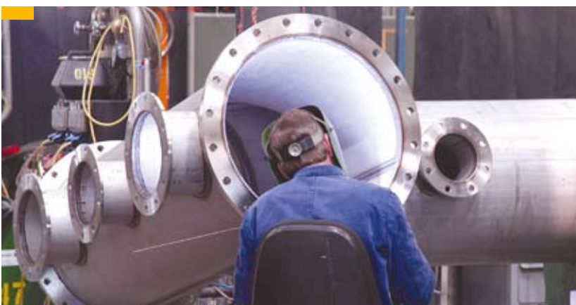
Ein hoher Vorfertigungsgrad verringert den Personalbedarf auf der Baustelle
